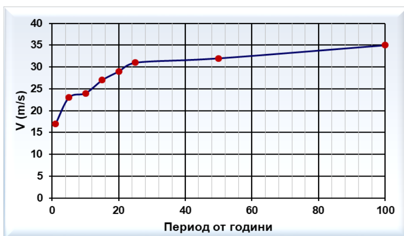
Фигура № 1.3.8. Максимална скорост на вятъра (V), възможна 1 път на определен период от години, ст. Велико Търново
